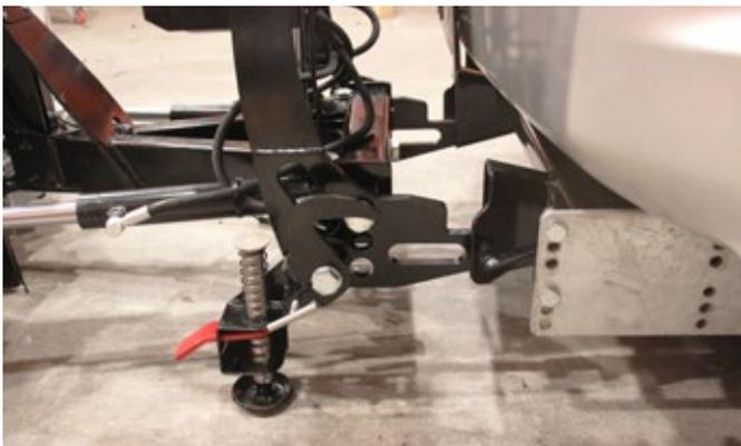
Attache Quick Hitch – système de montage rapide.
